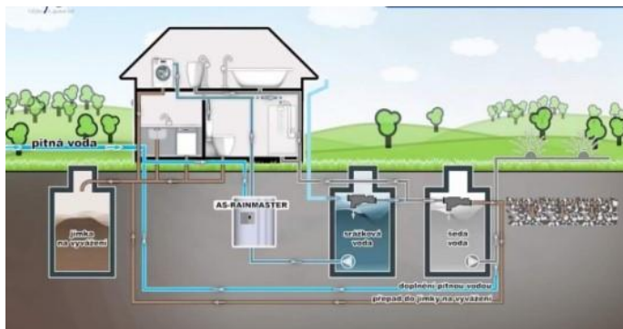
Systém pro recyklaci šedých vod
